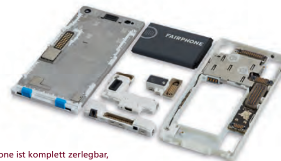
Das Fairphone ist komplett zerlegbar, sodass Komponenten ersetzt werden können. Die Rohstoffe stammen aus möglichst umwelt- und sozialverträglichem Bergbau. Foto: Flickr
